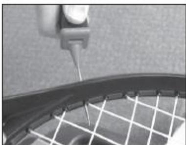
Комплект поставки включает в себя специальное шило для натяжки струн, которое можно вставить в зазор между струной основы и отверстием в ободке ракетки. Использование этого инструмента упрощает и ускоряет процесс натяжки поперечных струн. Перед вводом шила в ободок ракетки не забудьте закрыть в нем отверстие, предназначенное для струны.
