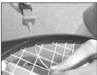
Когда шило введено в ободок ракетки, потяните его на себя за ручку, при этом неподвижно удерживая его иглу в ободке ракетки. В образовавшееся отверстие на конце шила вставьте струну.
