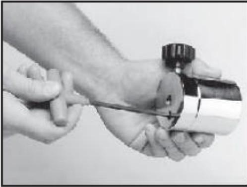
Грузило состоит из двух частей. В собранном состоянии оно позволяет устанавливать натяжение от 20 до 90 фунтов. Для установки натяжения от 8 до 20 фунтов, удалите болт 5мм с поверхности грузила и продолжайте работу по тому же принципу, что приведен выше.
