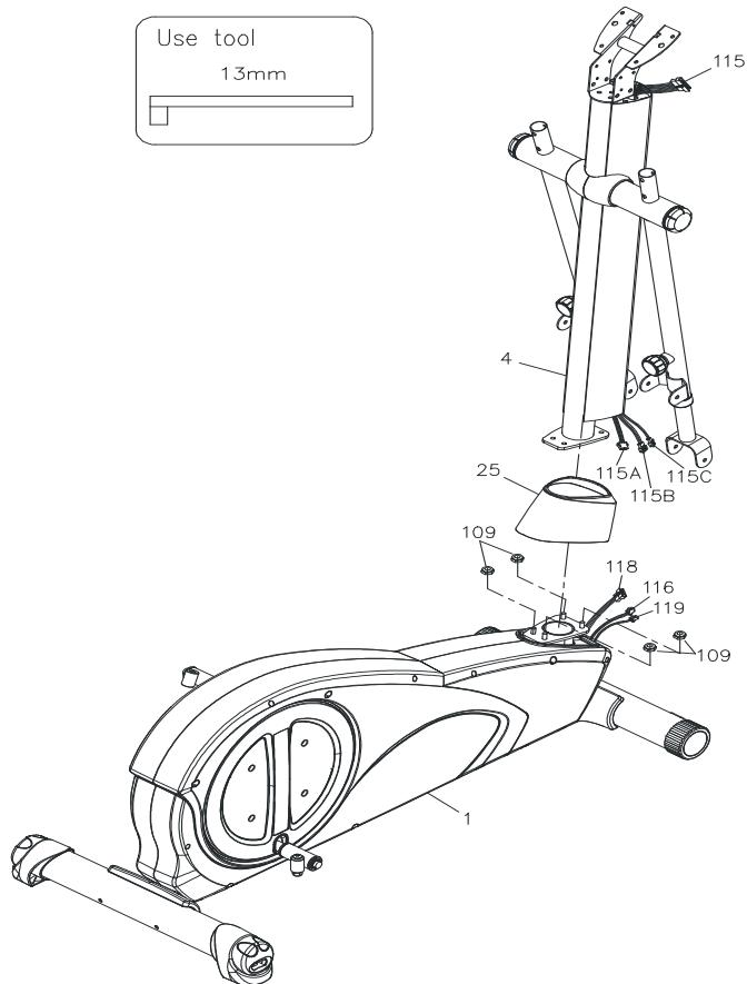
Примечание: Во избежание повреждений во время транспортировки гайки (M8) (109) закреплены на основной раме (1), как изображено на рисунке.
